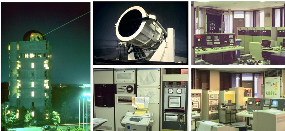
A-2 大型スキャンングライダー (波長 532 nm) (1979-2008), 東芝製. (左) 全景. (中央上) 送受信系. 送信部: Nd:YAG レーザー. パルスエネルギー 400 mJ (532 nm), 繰り返し 25 パルス/秒. 受信望遠鏡は口径 1.6 m, カセグレン型. (右上) 操作卓とレーザー電源. レーザーはオシレータと 3 段のアンプ. (右下) 架台制御装置, データ収集装置. トランジェントレコーダは岩通 DM-902. (中央下) 測定制御, データ収集用コンピュータ. 東芝 TOSBAC 7-40. データはオープンリールの磁気テープに記録.
