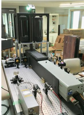
A-6 多波長ラマン散乱ライダーとHSRL。(左) 多波長ラマン散乱ライダー (2012-)。1064 nm, 532 nm, 355 nm で後方散乱, 532 nm, 355 nm で消散および偏光解消度を測定。写真は九州大学。(右) 干渉計を使ったマルチモードHSRLの実験システム (写真は2016)。
