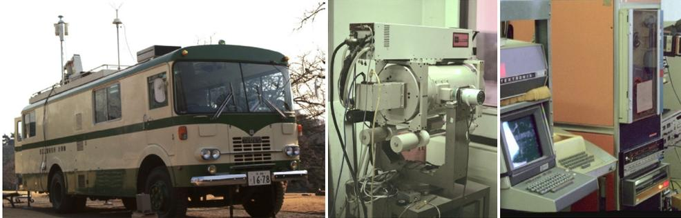
A-1 車載型スキャンングライダー (波長 1064 nm) (1978-85 ごろ). (左) 全景. (中央) 送受信系. 送信部: 東芝製 Nd:YAG レーザー. 繰り返し 20 パルス/秒. ウェッジプリズム 2 枚のビームアライメント装置. 受信部: 口径 30 cm のカセグレン型望遠鏡 (清原光学製), 光電子増倍管は RCA-7102 型, 量子効率 0.03% (1064 nm). (右) 信号処理記録系. トランジェントレコーダは岩通 DM-901 (8bit, 1024 セグメント, 100M サンプル/秒), コンピュータは NOVA-02. データはオープンリールの磁気テープに記録.
