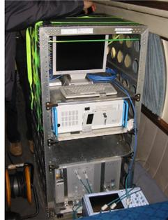
A-5 連続自動観測ライダーのバリエーション。(上) 海洋地球研究船「みらい」搭載ライダー (1999頃-2011)。二波長 (1064 nm, 532 nm) 偏光ライダー (532 nm) (下) 航空機搭載ライダー (2003頃)。偏光ライダー 355 nm。
